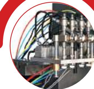
Usar el sistema common rail para el control de los inyectores HEUI
